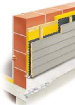
Wandaufbau der Massivbauweise.
