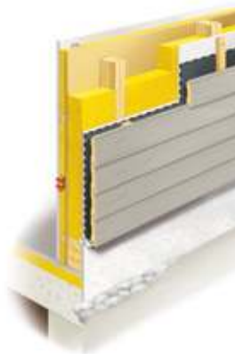
Wandaufbau der Holzskelettbauweise.
